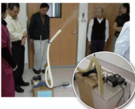
圖1 自製超音波微粒次氯酸噴霧器
